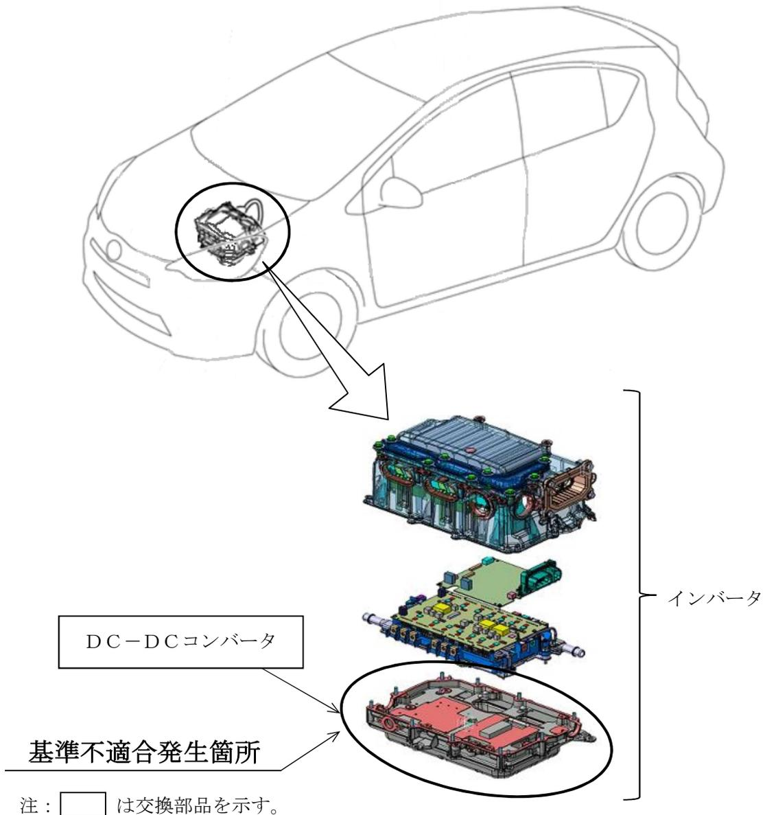
電圧変換装置（DC-DCコンバータ）において、生産設備の管理が不適切なため、制御基板の半田付けが不十分なものがある。そのため、走行中に半田が剥離して、補機バッテリーへの充電ができなくなることで警告灯が点灯し、最悪の場合、ハイブリッドシステムが停止して走行不能となるおそれがある。
