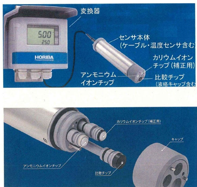
図 9 - 1 6 アンモニアセンサー変換器と検出部
