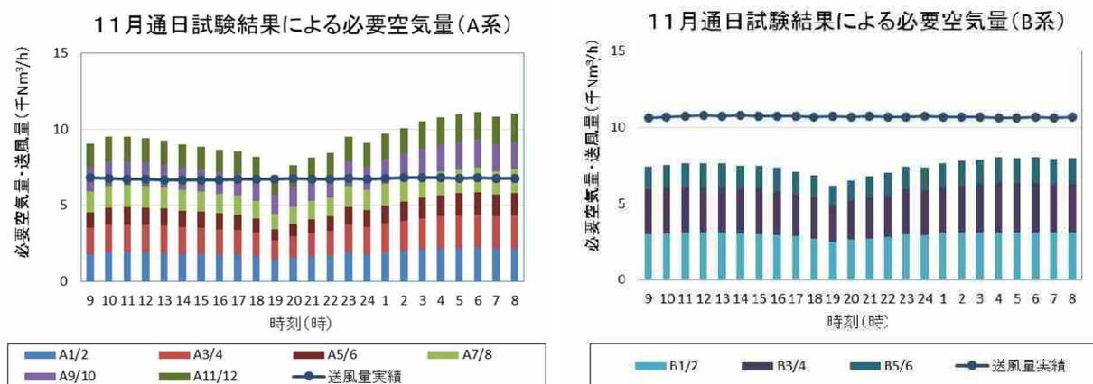
図 2-5-15 必要空気量と送風量実績の比較（11月）
