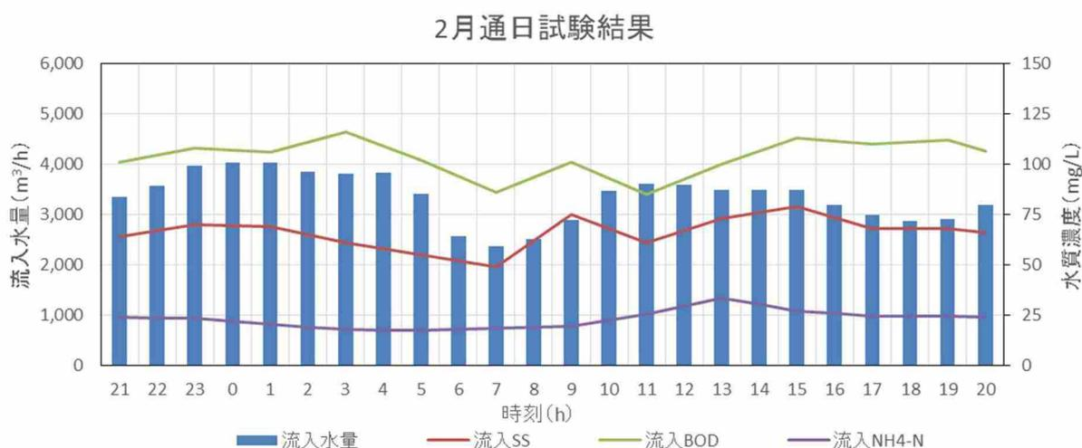
図 2-4-20 反応タンク流入水質の通日試験結果 (2月)
