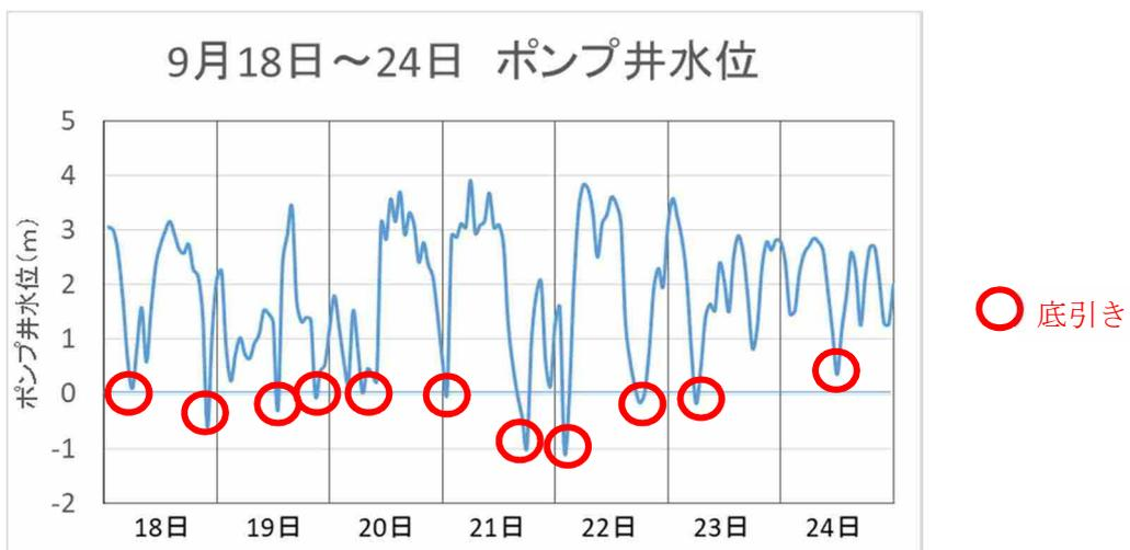
図 2-3-4 ポンプ井水位の変動パターン
