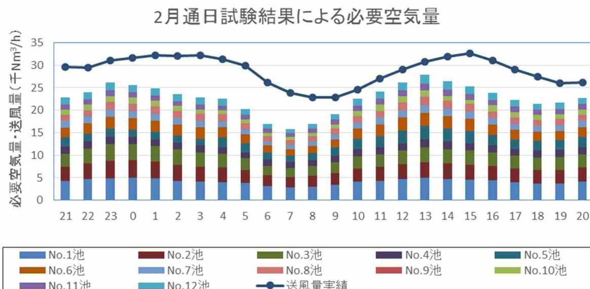
図 2-4-21 必要空気量と送風量実績の比較 (2月)
