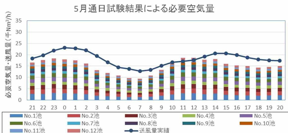
図 2-4-15 必要空気量と送風量実績の比較 (5月)
