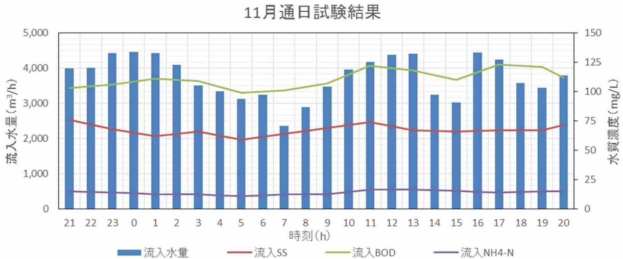
図 2-4-18 反応タンク流入水質の通日試験結果 (11 月)
