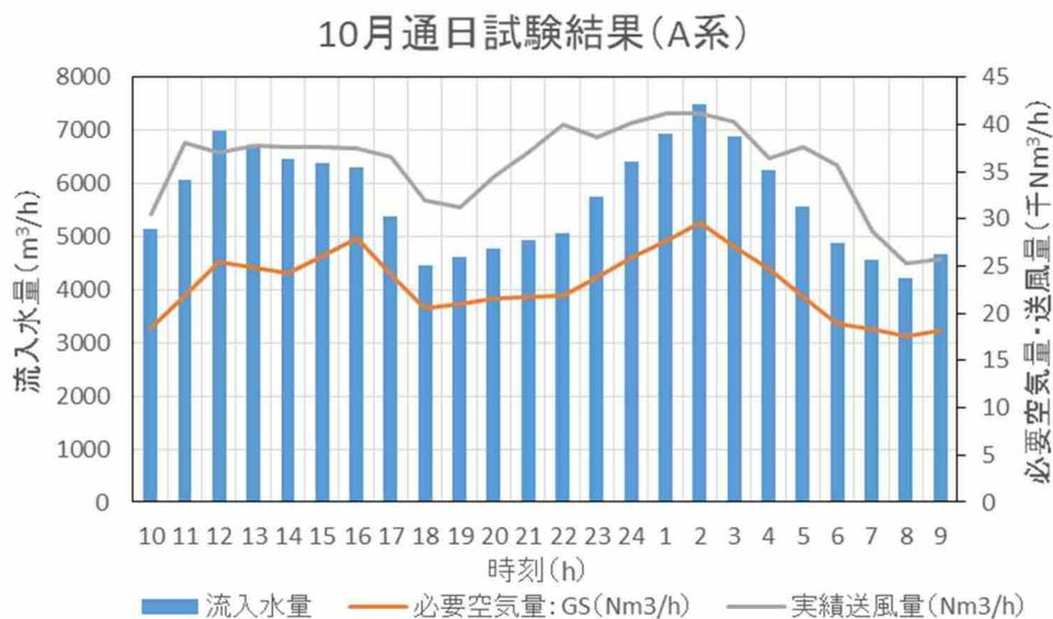
図 2-3-6 必要空気量と送風量実績の比較 (A系)
