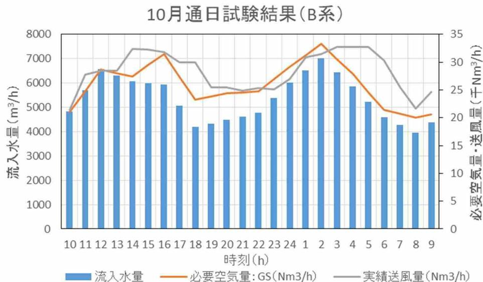
図 2-3-7 必要空気量と送風量実績の比較 (B 系)
