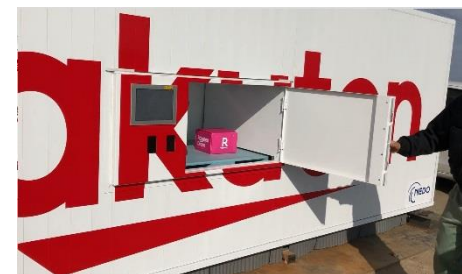
荷物収納機能を持つ電子鍵付きドローンポート
