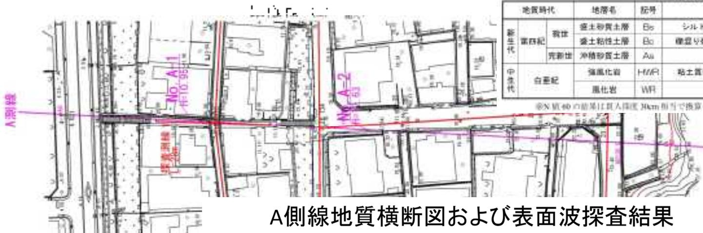
A側線地質横断図および表面波探査結果
