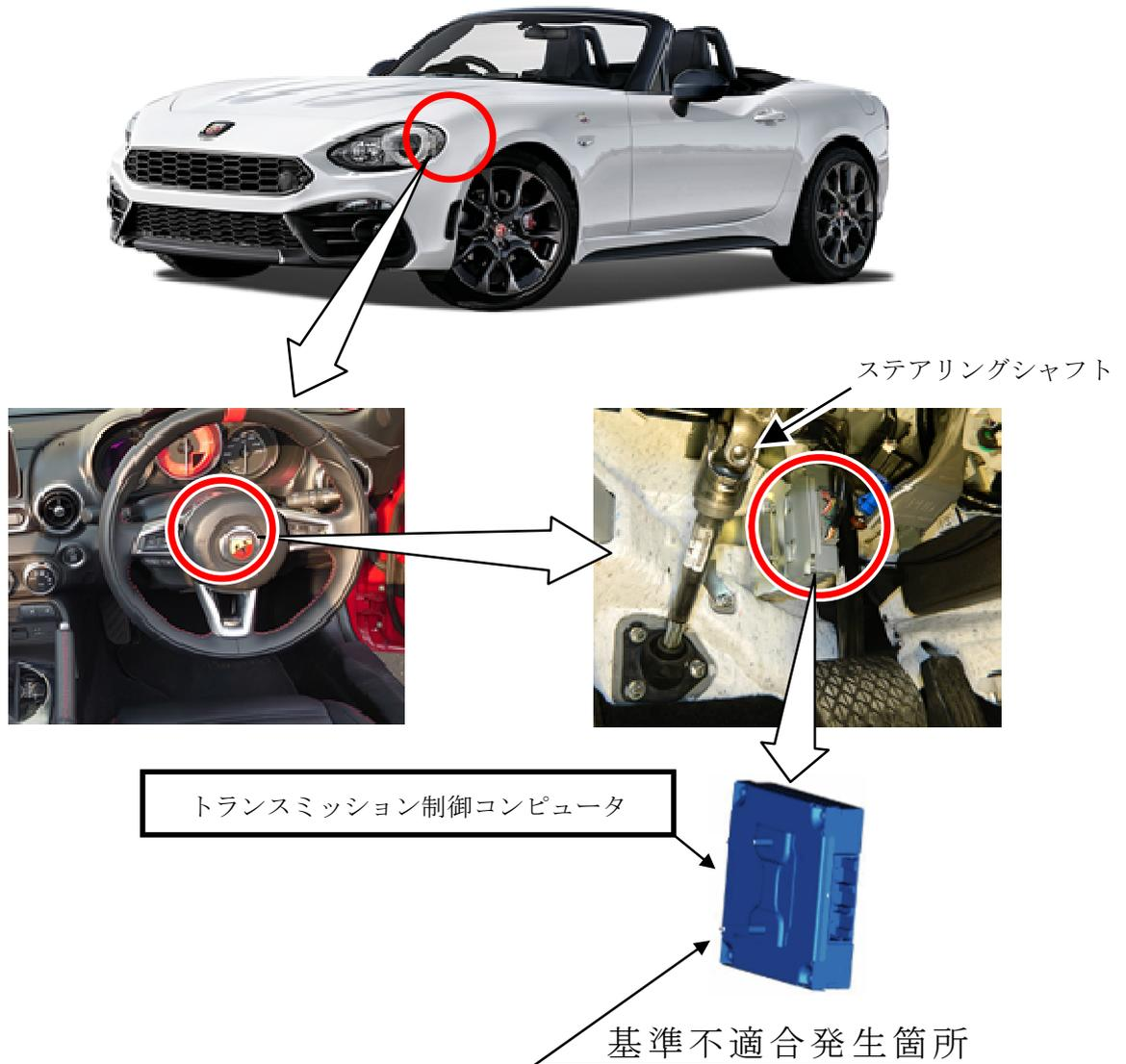
自動変速機搭載車のトランスミッション制御コンピュータにおいて、クラッチ制御プログラムが不適切なため、Dレンジ（マニュアルモード含む）で走行中にレンジ信号ノイズを検出した場合に、意図しないクラッチ制御が作動することがある。そのため、減速感を伴うショックが発生し、最悪の場合、走行安定性を損なうおそれがある。
