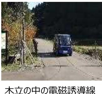
木立の中の電磁誘導線による自動走行の様子
