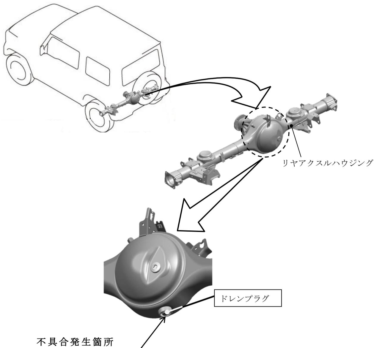
後付け用品として販売したリミテッドスリップデフキットの取付説明書において、リアアクスルハウジングのドレンプラグ締付トルクの記載が誤っているため、当該キット取付け時にドレンプラグの締付けが不足することがある。そのため、走行振動等により当該ドレンプラグが緩み、デファレンシャルオイルが漏れるおそれがある。
