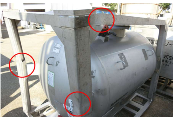
写真 11-1 希硫酸コンテナタンク (○は損傷部分)
