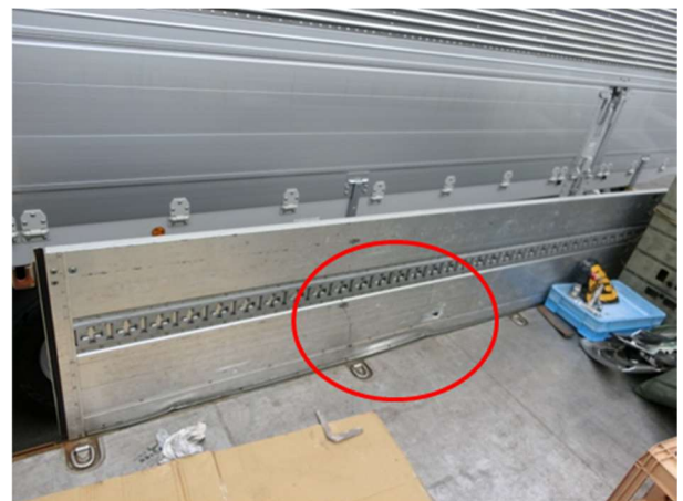
写真 5 当該車両荷台左側あおりの損傷部分
