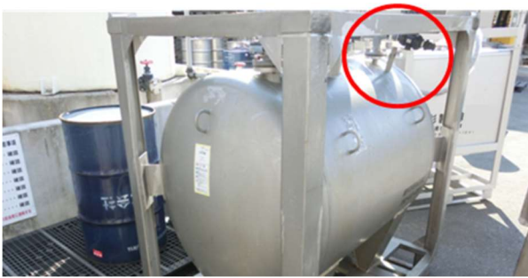
写真 10-1 塩酸コンテナタンク 2 (○は損傷部分)
