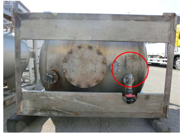
写真 9-2 塩酸コンテナタンク 1 (○は損傷部分)
