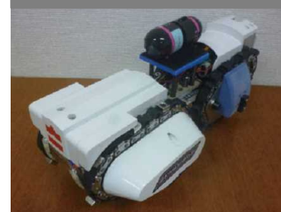
天井裏配線作業ロボット
