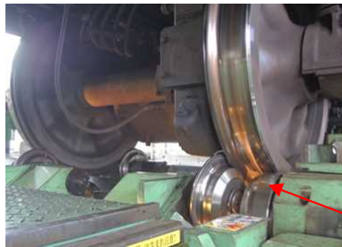
写真：車輪の削正状況
