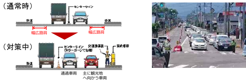
臨時的な2車線運用のための幅広路肩の活用 ＜北海道中富良野地区の取組事例＞
