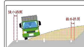
<狭小路肩のため被災により通行不可>
