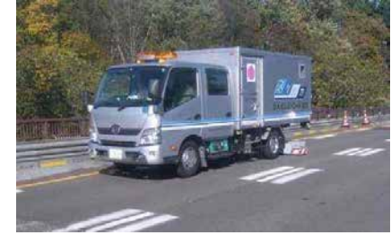
＜電磁波レーダー搭載車による床版上面の調査＞
