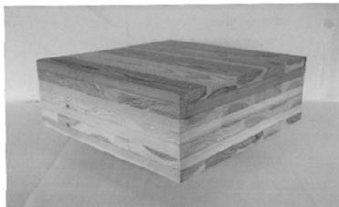
ラミナ(板材)を繊維方向が直交するように積層接着した集成パネル。
