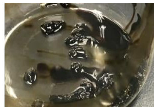
ゲル状のスラッジ
