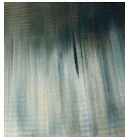
ボアポリッシュが発生し一部ウェーブカットの溝が無くなったシリンダライナ
