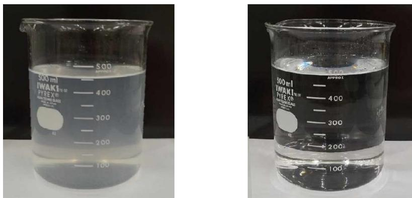
目幅 0.3mm のスクリーンを通過した排水（左：SS＝約 50mg/L）と水道水（右）
