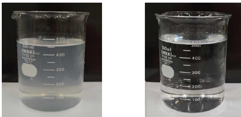
目幅 0.3mm のスクリーンを通過した排水（左：SS＝約 50mg/L）と水道水（右）
