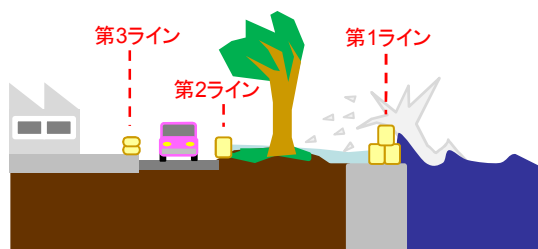
土のうによる3重防護のイメージ
