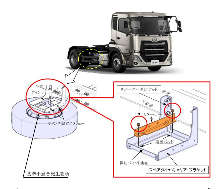
大型トラクタのスペアタイヤキャリアにおいて、ブラケットに溶接されたリテーナー固定ボルトの強度が不足しているため、リテーナー固定ナットを規定トルクで締め付けると、当該ボルトが引張荷重で伸びることがある。そのため、走行時の振動等によりボルトが破断し、最悪の場合、ウインチの固定スクリューが折損してブラケットから外れ、スペアタイヤとともに脱落するおそれがある。
