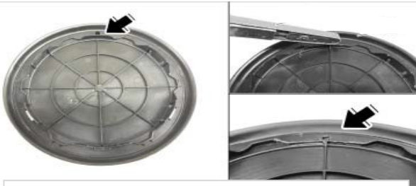
燃料ポンプサービスホールカバー（下面）の加工
