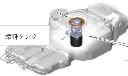
燃料フィルタフランジ (吐出パイプ：矢印)
