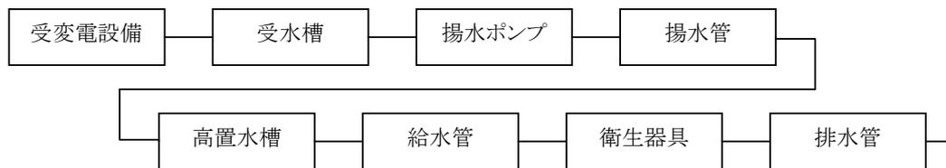
図 3.4.1 直列に連結したシステムの例（給排水機能）
