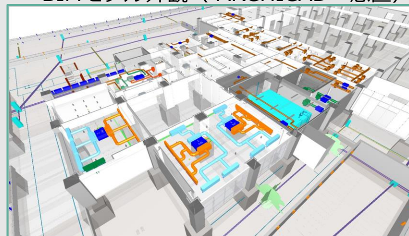
BIMモデル平断面 ( Rebro - 設備 )
