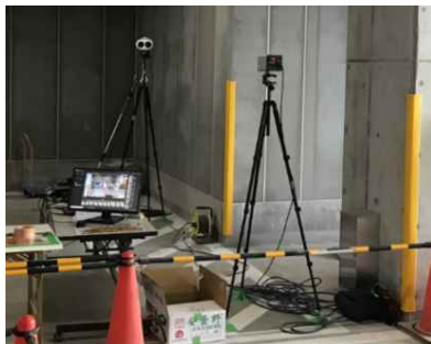
現場等の入口にサーモグラフィ等を設置し、体温を測定
