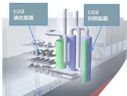
図 付録-8: CO 2 回収装置及び CO 2 液化装置の配置イメージ
