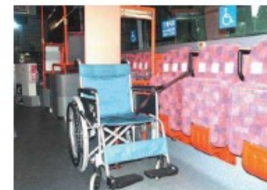
後向き・背もたれ板式車いす固定装置 横ベルトで車いすを固定 (写真は国土交通省の試作試験車)
