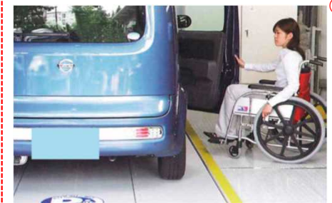
車椅子利用者対応の機械式駐車装置の例 (フルフラット化)
