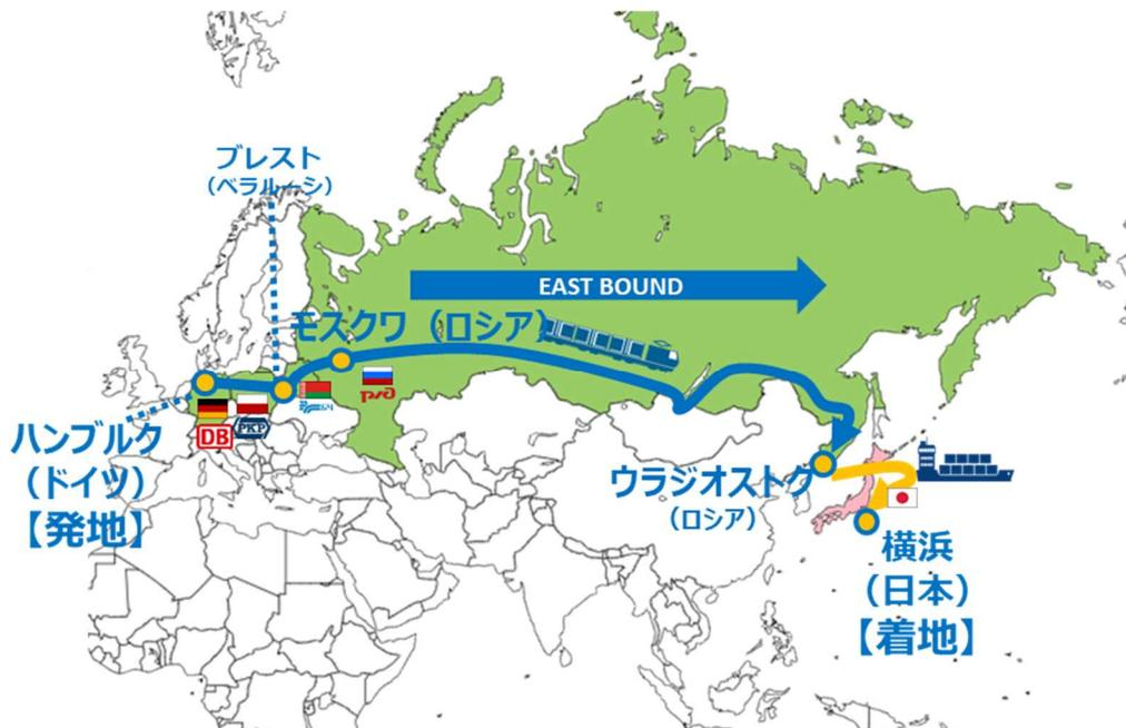
尚、本ルートでは輸送途上に2回以上のコンテナの積替え荷役が発生することが想定された。第一にポーランドとベラルーシの国境、第二にウラジオストクである。ドイツ、ポーランドは鉄道のレール幅、つまり、軌間が1,435 mmの標準軌であるのに対し、ベラルーシ、ロシアの軌間は1,520 mmの広軌である。そのため、それぞれの軌間にあった動力機関車、貨車を使用することになる。コンテナはベラルーシのブレストで標準軌の貨車から広軌の貨車に積替えられることが事前に想定された。
