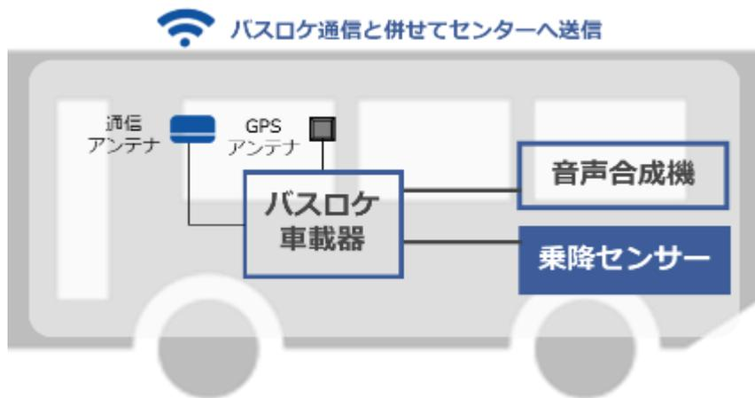
乗降センサーについては、バス停での乗車／降車数カウントだけでなく、**ODデータが取得可能なセンサー含め検討・実証中**
