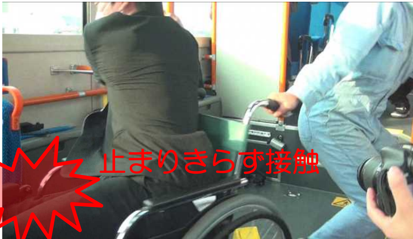
検証実験① 輪留めのみでの走行
