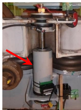
写真4 上下動ダンパ: 改良ダンパ
