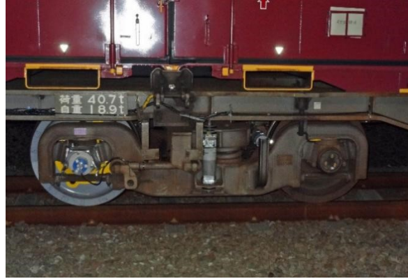
写真6 改良ダンパ装架台車(同)
