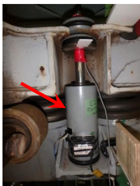
写真3 上下動ダンパ: 現行ダンパ
