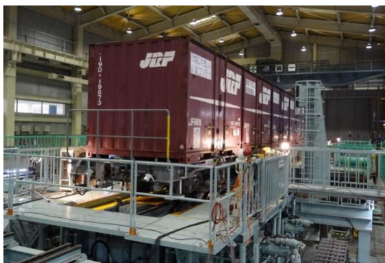
写真1 試験台上の供試車両
