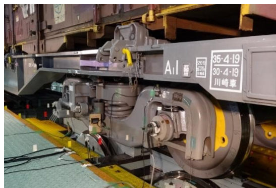
写真2 試験台上の供試台車(1位台車)
