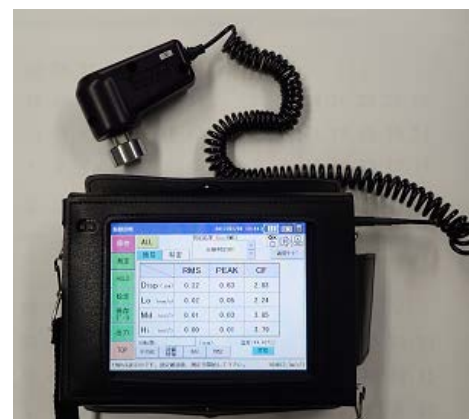
図3-10 マグネット式による事例
