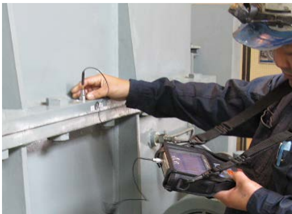
図3-10 マグネット式による事例
