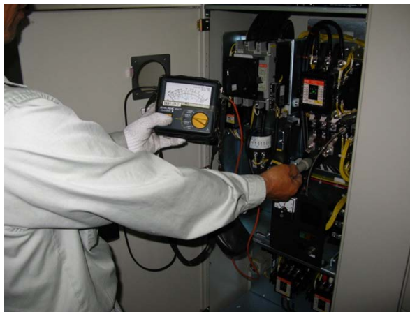
図 3-2 絶縁抵抗計測
