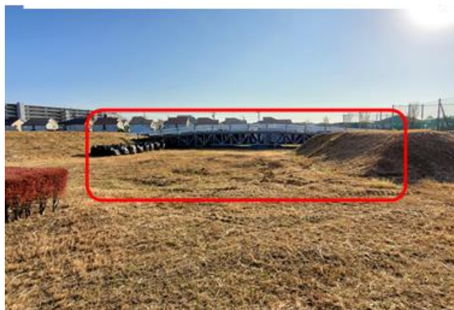
ヘリポート側はフレコンバッグ有り 【作業ヤードとしては不向き、地盤面も凹凸多数】
