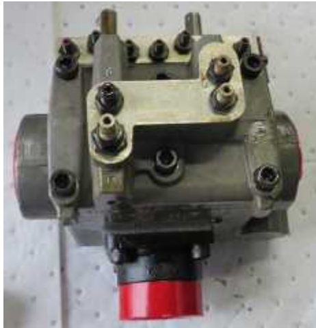
写真4 流量制御弁の外観（取り外し後）
