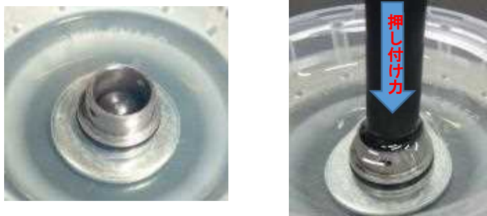
写真 12 鋼球押し付け試験
