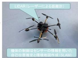
LIDARを活用した自動飛行ドローン
