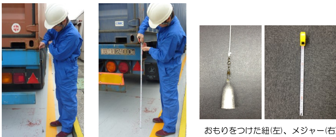
図 22 計測イメージと測定機材
