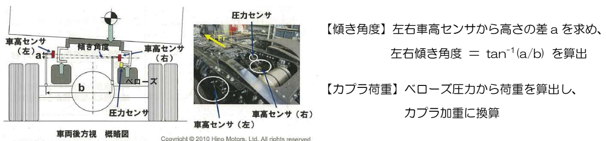
図36 左右傾きの検出原理
