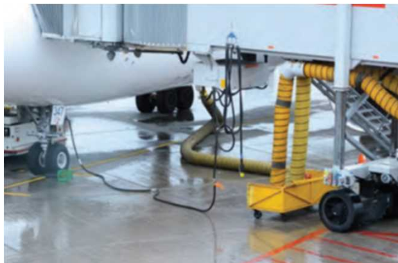
航空機と電源ケーブルとの接続状況
