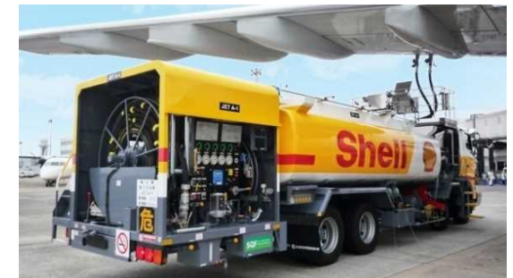
レフューラー：燃料タンクを装備し、航空機へ直接燃料を補給
