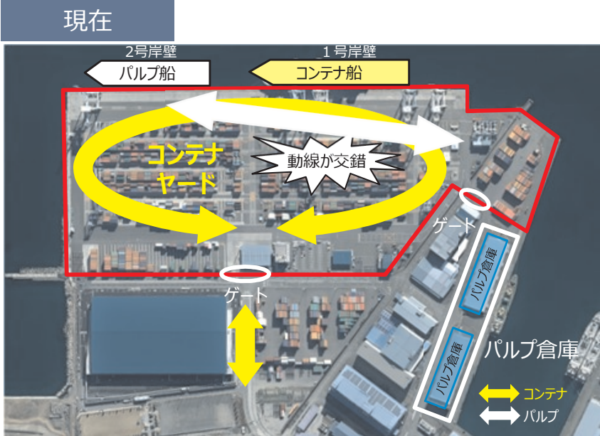
【新興津地区におけるパルプとコンテナの荷役動線の例】
