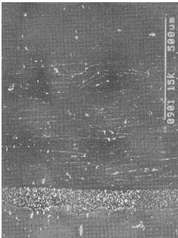
図3.3-2 ガラスフレーク塗膜断面
