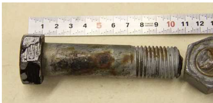
写真8 折損したボルト（頭側）の破断面
