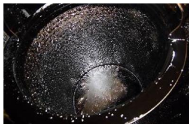
タンク底に沈殿していた 海苔状のスラッジ
