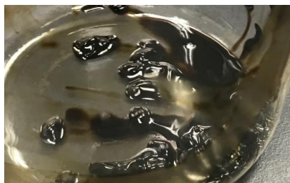
燃料油の温度が低下しワックス化したゲル状のスラッジ
