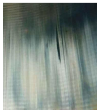
図3-2 ポアポリッシュが発生し一部ウェーブカットの溝が無くなったシリンダライナ
