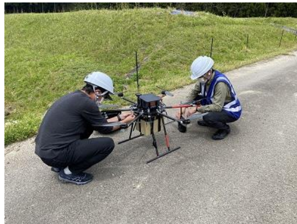
▲中継地点でのバッテリー交換
