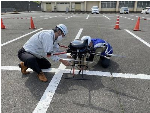
▲職員による飛行前点検及び荷物の搭載
