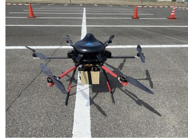
▲緊急物資(約1kg)を搭載した機体
