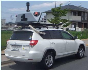
主要な基準点のみ現地測量し、MMS関係機材を搭載した車両で走行しながら計測したレーザ測量成果で現況測量を実施
