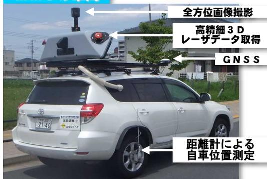
➢ MMSとは、車両にGNSS（全球測位衛星システム）等の自車位置姿勢データ取得装置及び3Dレーザスキャナ、カメラ等の数値図化用データ取得機器を搭載した計測・解析システム。
