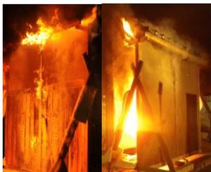
実験による板塀の燃え抜け防止性能の確認
