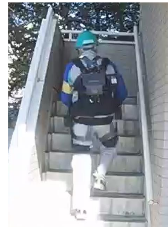
資材運搬の建物階段昇り (A2 装着)
