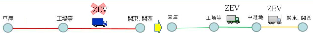
フィジカルインターネットによって輸送経路を切り分け、電動車両の導入可能性を検証。
