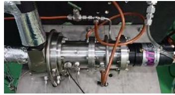
液体水素電動ポンプ技術 (少流量、高吐出圧、精密制御)
