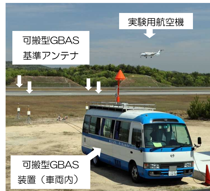
可搬型GBAS装置によるGLS精密進入経路の飛行実証実験 (RJOA RWY10/28) の様子
