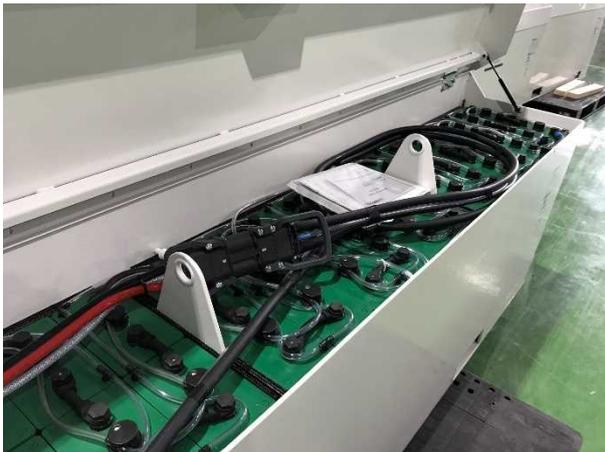
左の写真は実際に弊社が販売した車両に取り付けられているバッテリーの様子である。中央に見えるコネクタには、写真左側より黒、赤、透明の 3 本のチューブが入っているが、このうち透明のチューブが充電器から発生するエアーを全てのセルに送り届ける役割を果たしており、電解液を攪拌、1 回当たりの満充電に掛かる消費電力を少なくするように設計されている。
