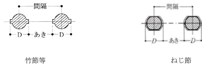
図 8.3.5 鉄筋相互のあき及び間隔
