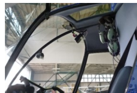
ロビンソン式R22Beta型 STCを承認(STC-472-OSA) 機体の電源系統を改修し接続。 WINDSHIELDを保持する中央BRACEにマウントを設置し、取り付け。 出所: 大阪航空
