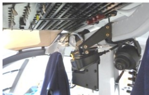
川崎式BK117C-2型 STCを承認(STC-471-OSA) 操縦席構造部にマウントを設置し、取り付け。電源は既存の機体補助電源に接続。 出所: 徳島県消防防災航空隊
