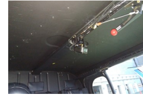
ベル式505型 STCを承認(STC-480-TYO) 操縦席天井にサポートアームを設置し取り付け。電源は既存の機体補助電源に接続。 出所: 海上保安庁
