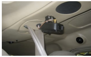
セスナ式172S型 STCを承認(STC-148-HQT) 機体の電源系統を改修し接続。内装にマウントを設置し取り付け。 出所: 本田航空
