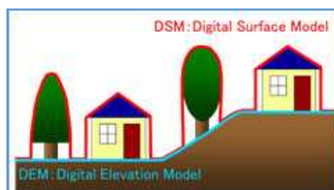
図16 DEMとDSMの概念図
